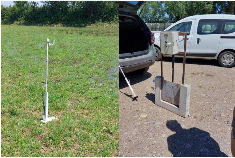
Détecteur de bout de champ (à gauche) et prototype de martelière automatique (à droite)
